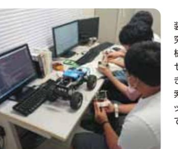
最新の機器や手作りの実験装置を用いて大学レベルの研究を行っています。写真は機械システム工学科の学生が、センサーから得た情報に基づき立体地図を作成し、経路探索ができる自律移動型のロボットを設計・製作している様子です。
