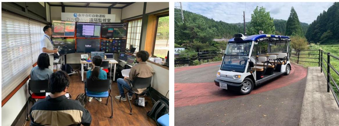
図 4. レベル 4 自動運転の監視室(左)と、自立走行型の無人運転車両(右)
